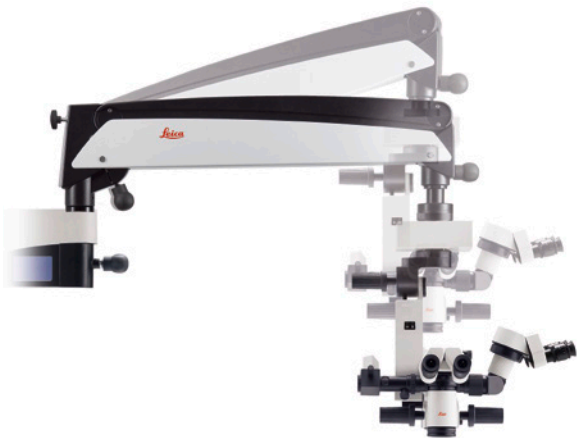
Intuitive Bedienelemente für Lichtintensität, Fokus, Zoom und X/Y-Geschwindigkeit.
